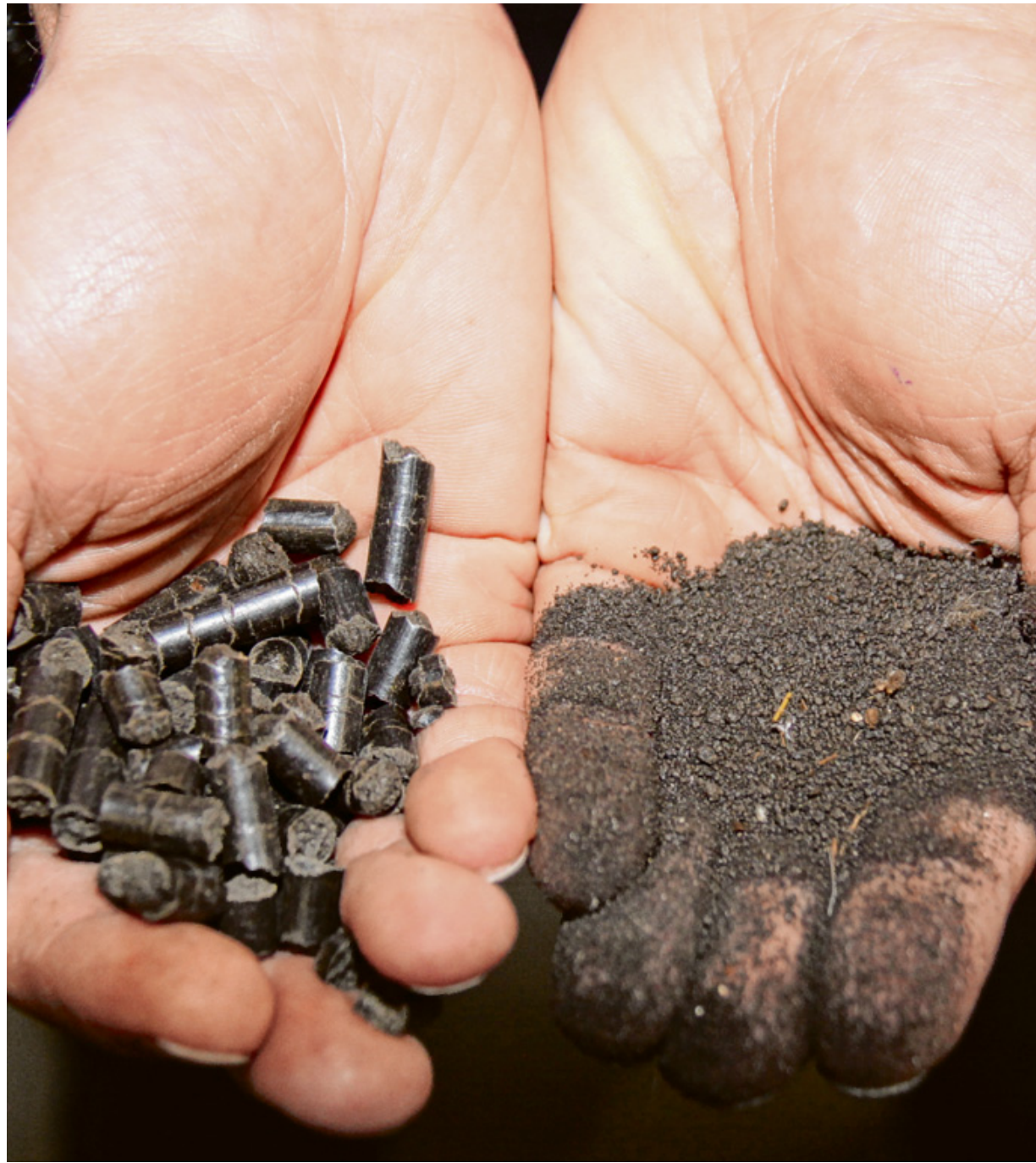
Aus Klärschlamm werden unbelastete Pellets, die weiterverwertet werden können. Getrockneter Klärschlamm (rechte Hand) wird zu Pellets gepresst (linke Hand).
